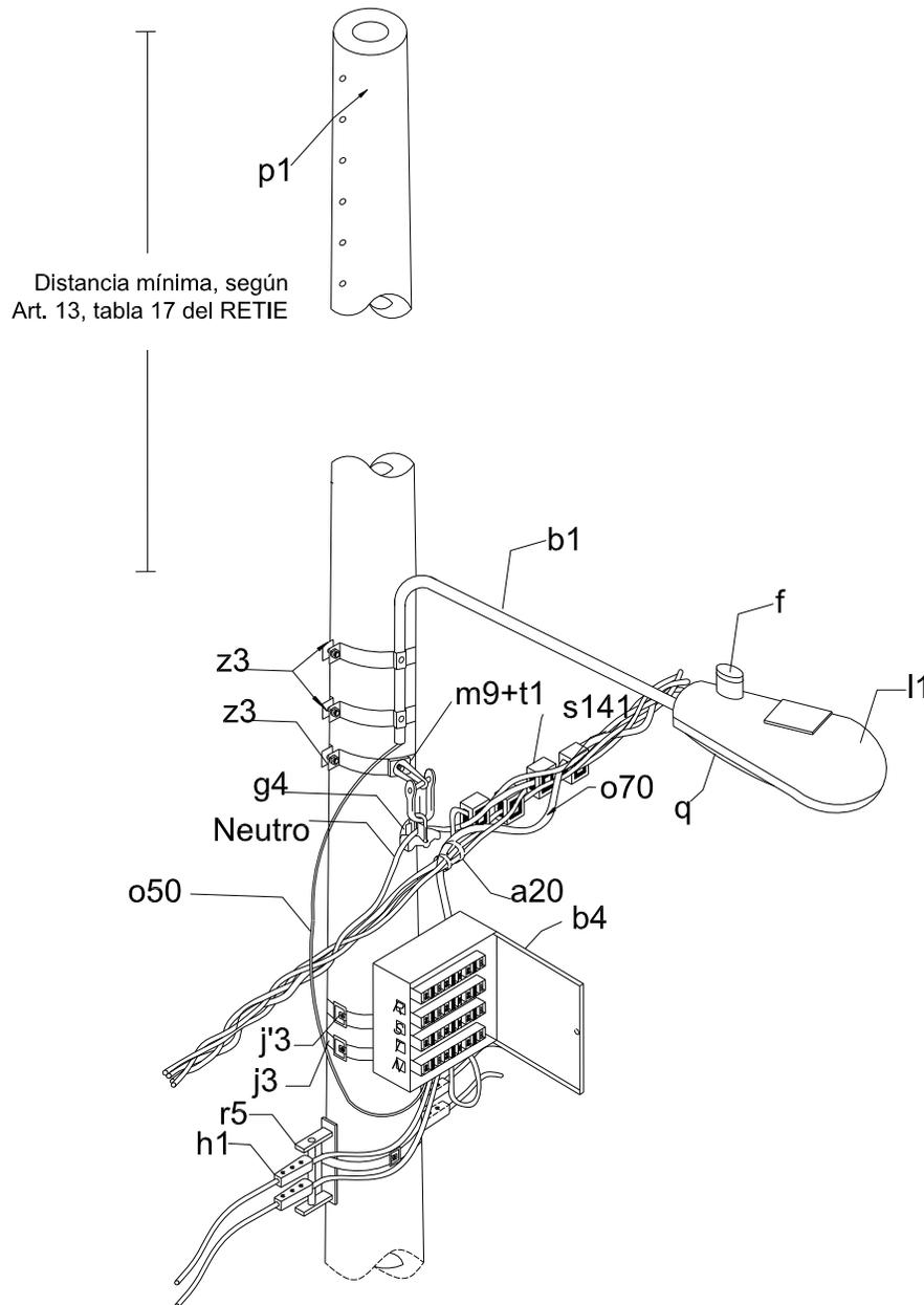
**PASO SENCILLO CON A.P EN RED TRENZADA, PARA CUALQUIER CONFIGURACIÓN DE CIRCUITO PRIMARIO**
