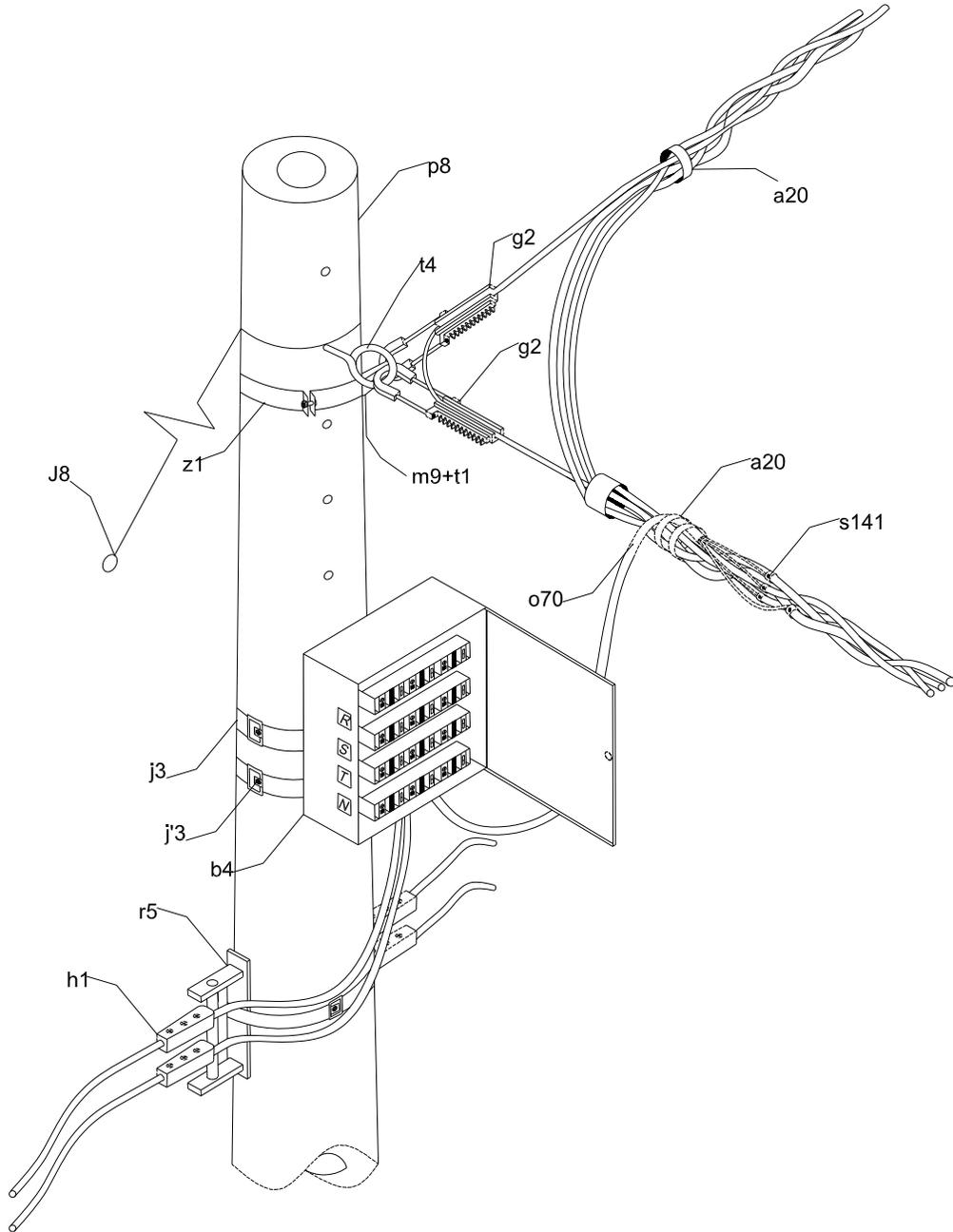
**RETENCIÓN DOBLE CONSTRUCCIÓN ANGULAR RED
